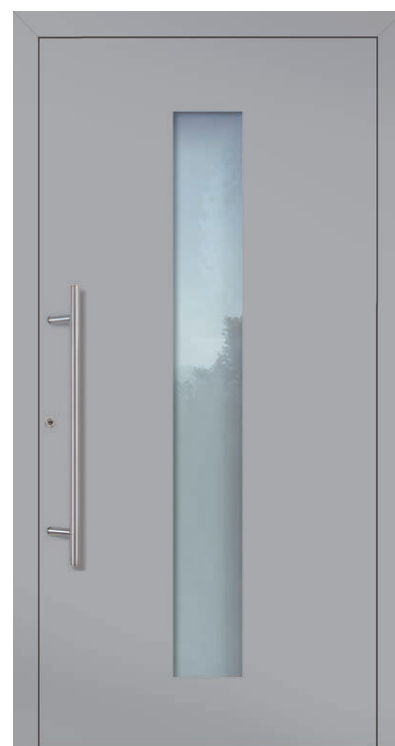
A 5 U_d -Wert 0,80 Farbe: RAL 9006 Weißaluminium FS Verglasung: Satinato weiß LA 200 x 1.600 mm Mindestmaß = 800 x 1.990 mm
